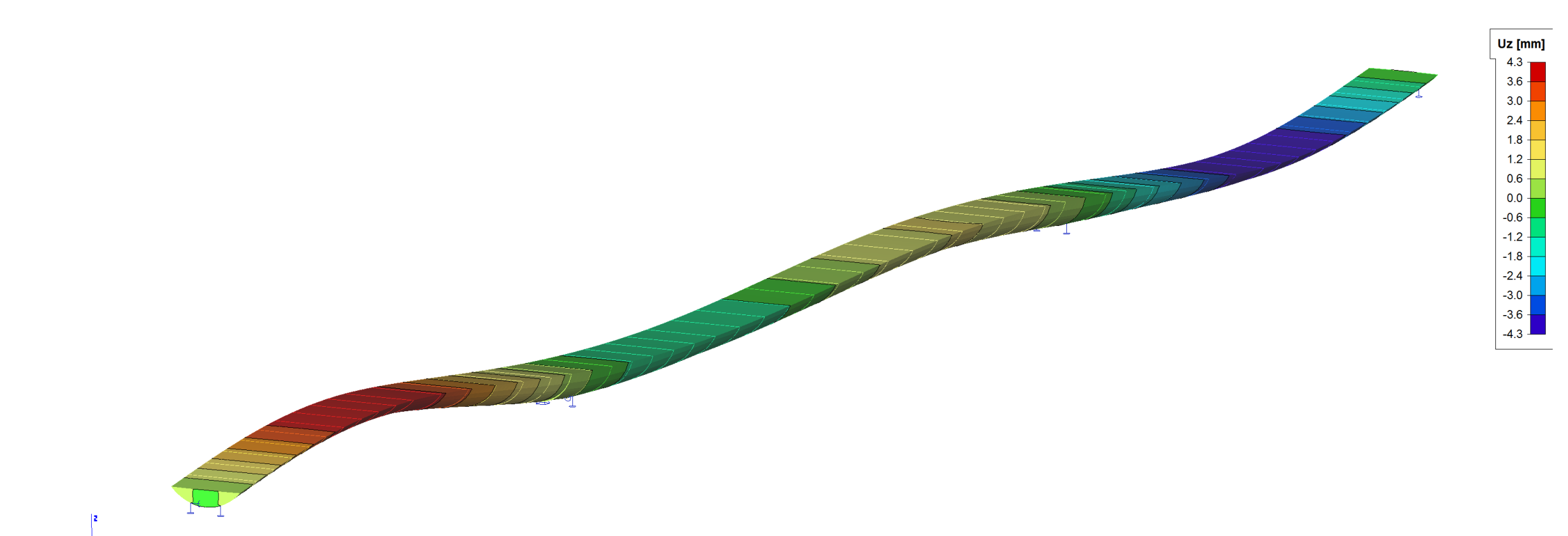
druhý vlastní svisle ohybový tvar - frekvence 2,0 Hz
